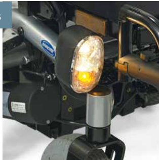
Versión 1: Invacare Stream 6 km/h con kit de luces; incluye intermitentes. Baterías 60 Ah.
